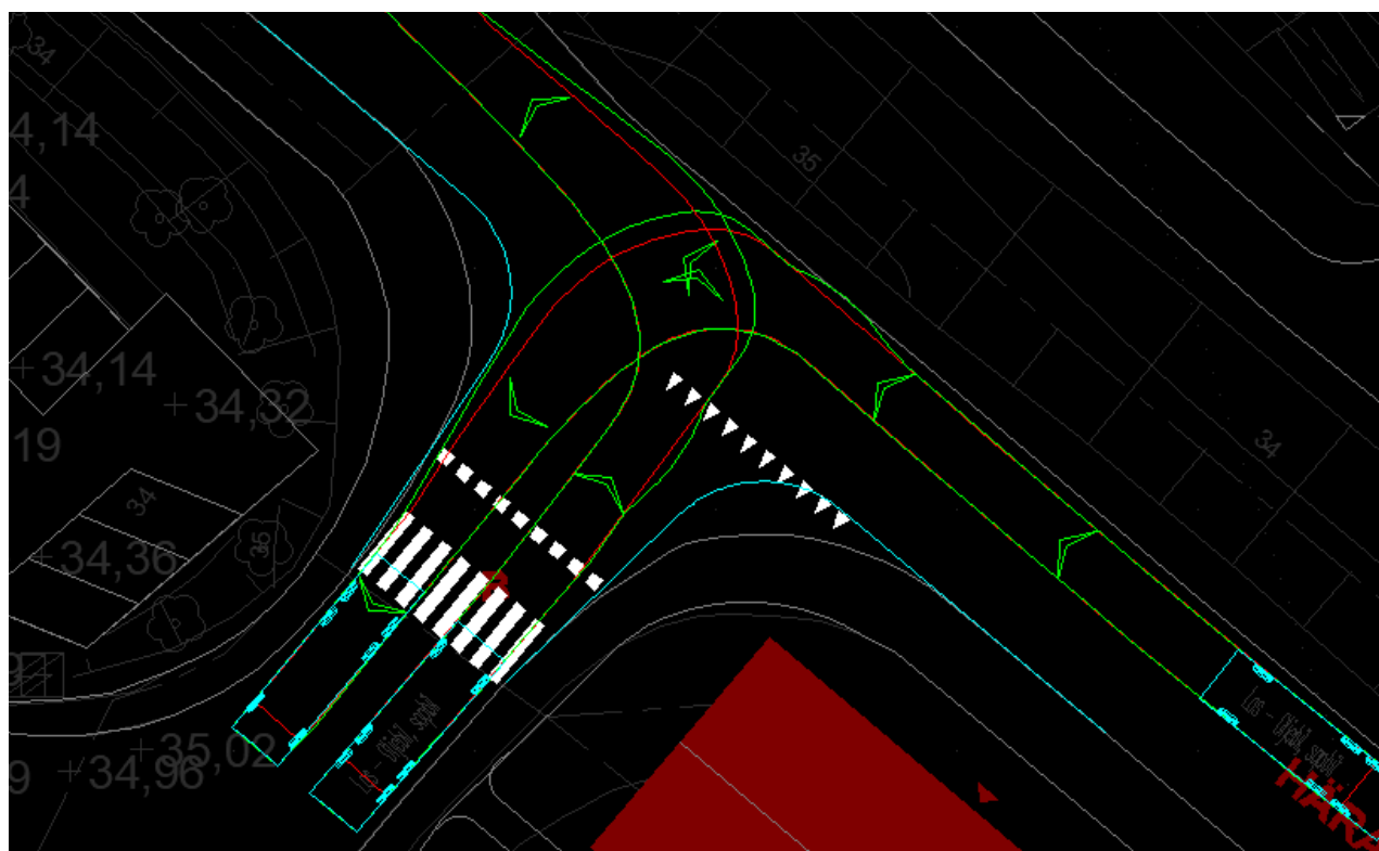
Figur 14 Körspår Los med justerad kantstensradie (R5) markerat i turkos.
